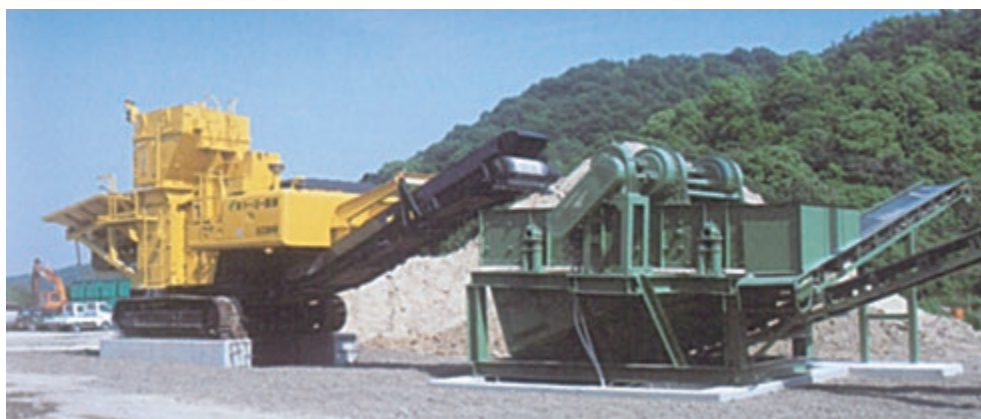
改良土プラント施設
